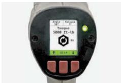
リチウムシリーズIIツールはトルクを直接測定するひずみゲージを組込み込んだ事でよりいっそう再現可能なトルクを提供します。操作能力を向上させたこのツールは、現在6,779Nmまで使用可能です。スライド式の方向スイッチ、着座トルク機能、ユーザーアクセスレベル、高度なボルディングなどの新たな機能はツールの用途をより広げました。
