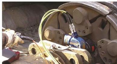
MXT-1型による大型車両組み立て
