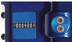
油圧トルクレンチMXT+には工具の使用を監視し、メンテナンスと校正をスケジュールするためのサイクルカウンターが組み込まれています。この機能は正確で再現性のあるボルト締め結果を得られます。また、工具を最高のパフォーマンスに維持するのに役立ちます。これにより作業者は可能な限り長い工具寿命を達成できます。
